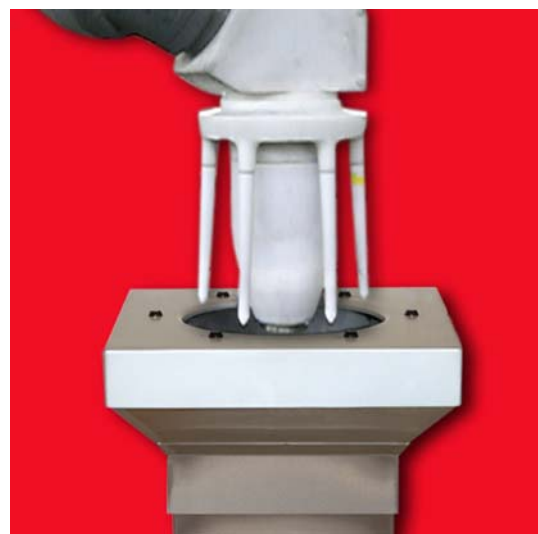
Der Farbzerstäuberreiniger während der Reinigung ein äußerlich geladener farbzerstäuber
